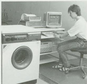
Um das optimale Programm von Waschvollautomaten zu ermitteln, ist eine universelle Steuerung im Einsatz. Die Software übernimmt die Aufgabe des Programmschaltwerks. Schrittweise wird ein Programmablauf eingegeben und vom Rechner umgesetzt. Das Waschprogramm läßt sich schnell und problemlos in allen Details modifizieren. Erst wenn sämtliche Meßwerte und Testergebnisse den Anforderungen entsprechen, wird das eigentliche Schaltwerk aufgebaut.
