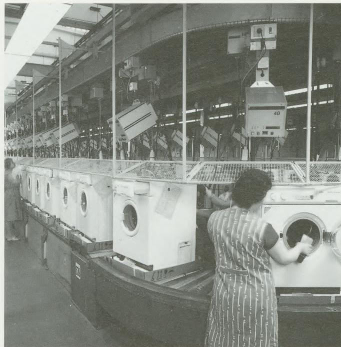
Jeder fertig montierte Lavamat durchläuft ein repräsentatives Waschprogramm und absolviert eine umfassende Sicherheitsprüfung. Sämtliche Leistungsdaten, wie Waschtemperaturen, Wasserstände, Trommeldrehzahlen, werden erfaßt und in einem Prüfprotokoll festgehalten.
