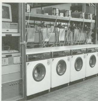
Zur Qualitätssicherung gehören die Überprüfung von Seriengeräten und umfangreiche Lebensdauer- und Zuverlässigkeitstests. Neue Geräte müssen weit vor Abschluß der Entwicklung einen möglichst praxisnahen „Rund-um-die-Uhr-Waschbetrieb“ absolvieren. Meßdaten werden von rechnergesteuerten Prüfeinrichtungen erfaßt und gespeichert.
