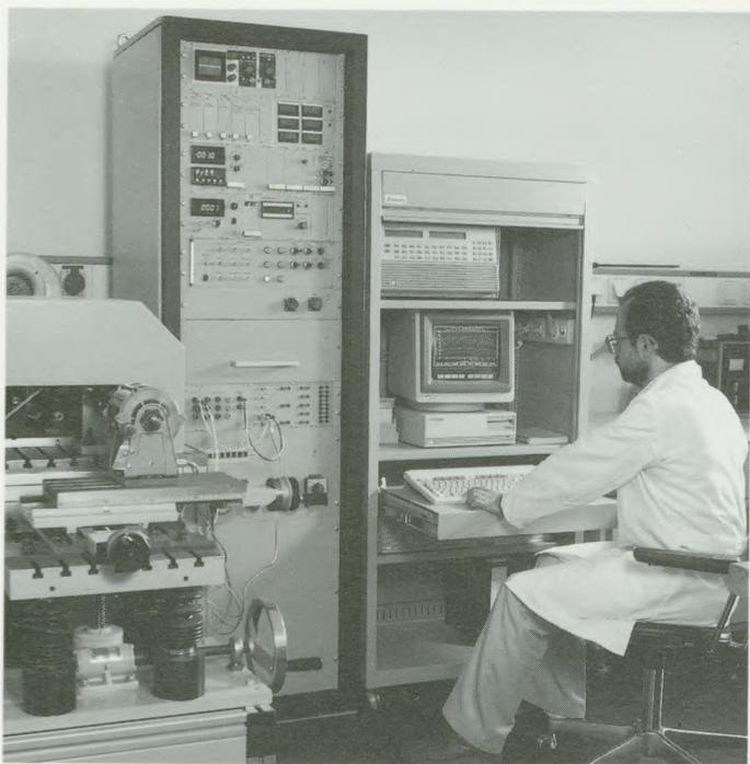
Auf dem Prüfstand werden Motoren für Waschautomaten, Wäschetrockner und Geschirrspüler auf Herz und Nieren getestet. Vollautomatisch erfaßt er Drehzahl, Drehmoment, Leistung, Spannung, Wirkungsgrad und meldet diese Daten einem Rechner zur weiteren Aufbereitung. Die Anlage ist für Motoren von 10 W bis 8000 W Abgabeleistung ausgelegt und wird für Neuentwicklungen und Qualitätsüberwachungen der laufenden Fertigung eingesetzt.
